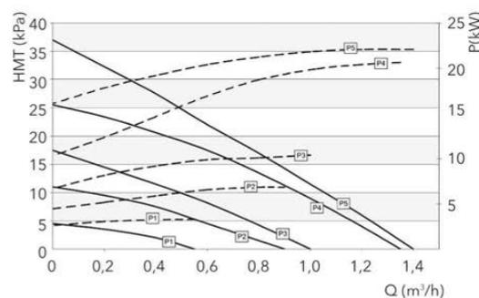
Les caractéristiques des courbes dépendent du type de circulateur, de la vitesse de rotation et de la tension.
