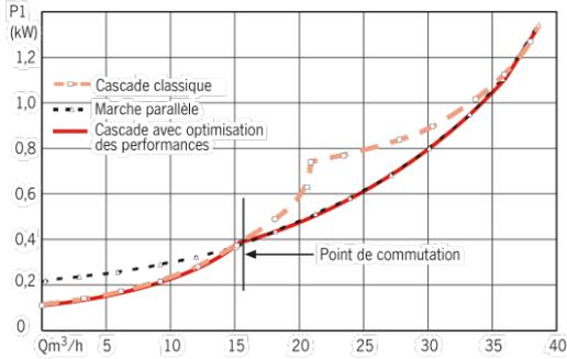
Fonctionnement en cascade d'un Siriu master équipé de deux modules IF. A débit équivalent, le circulateur utilise automatiquement la courbe de moindre puissance.
