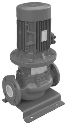
Électropompes centrifuges in-line avec système hydraulique en fonte, à roue simple, conçues conformément à la norme DIN 24255. Équipées d'un moteur normalisé.
