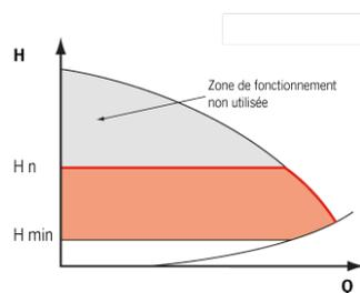
L'électronique maintient constante, via le régime de débit autorisé, la pression différentielle produite par la pompe à la valeur de pression différentielle de consigne H<sub>n</sub>, jusqu'à la courbe de fonctionnement caractéristique maximale.
