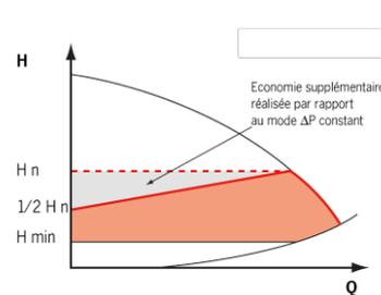
L'électronique modifie de façon linéaire entre H<sub>n</sub> et 1/2 H<sub>n</sub> la valeur de pression différentielle de consigne à respecter par la pompe. La valeur de pression différentielle de consigne H augmente ou diminue avec le débit demandé.
