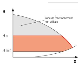
L'électronique maintient constante, via le régime de débit autorisé, la pression différentielle produite par la pompe à la valeur de pression différentielle de consigne  $H_n$ , jusqu'à la courbe de fonctionnement caractéristique maximale.
