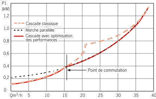
Fonctionnement en cascade d'un Sirlux master équipé de deux modules IF. A débit équivalent, le circulateur utilise automatiquement la courbe de moindre puissance.
