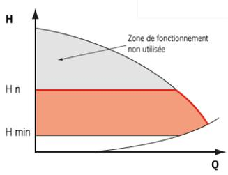
L'électronique maintient constante, via le régime de débit autorisé, la pression différentielle produite par la pompe à la valeur de pression différentielle de consigne  $H_n$ , jusqu'à la courbe de fonctionnement caractéristique maximale.
