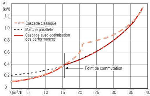
Fonctionnement en cascade d'un Sirix master équipé de deux modules IF. A débit équivalent, le circulateur utilise automatiquement la courbe de moindre puissance.
