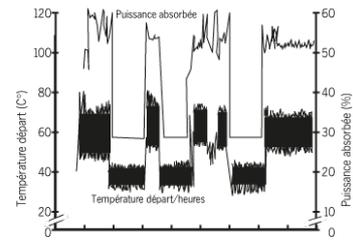
Ce dispositif permet de réaliser jusqu'à 25% d'économie supplémentaire par rapport à un fonctionnement en  $\Delta P$ -constant. Lorsque l'installation de chauffage atteint une certaine température basse, le circulateur tourne sur une vitesse constante réduite jusqu'à une nouvelle élévation de température.
