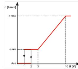
Commande à distance de la vitesse par signal 0-10 V
