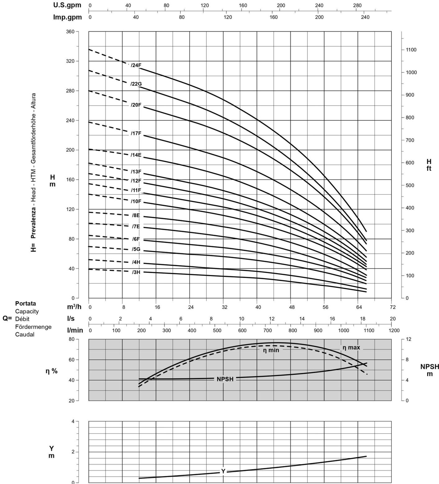
Curve per liquidi aventi densità 1000 kg/m<sup>3</sup> - viscosità 1 mm<sup>2</sup>/s alla temperatura di 20°C
