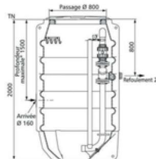
\* Profondeur maximale du fil d'eau d'arrivée par rapport au niveau TN (Terrain Naturel)
