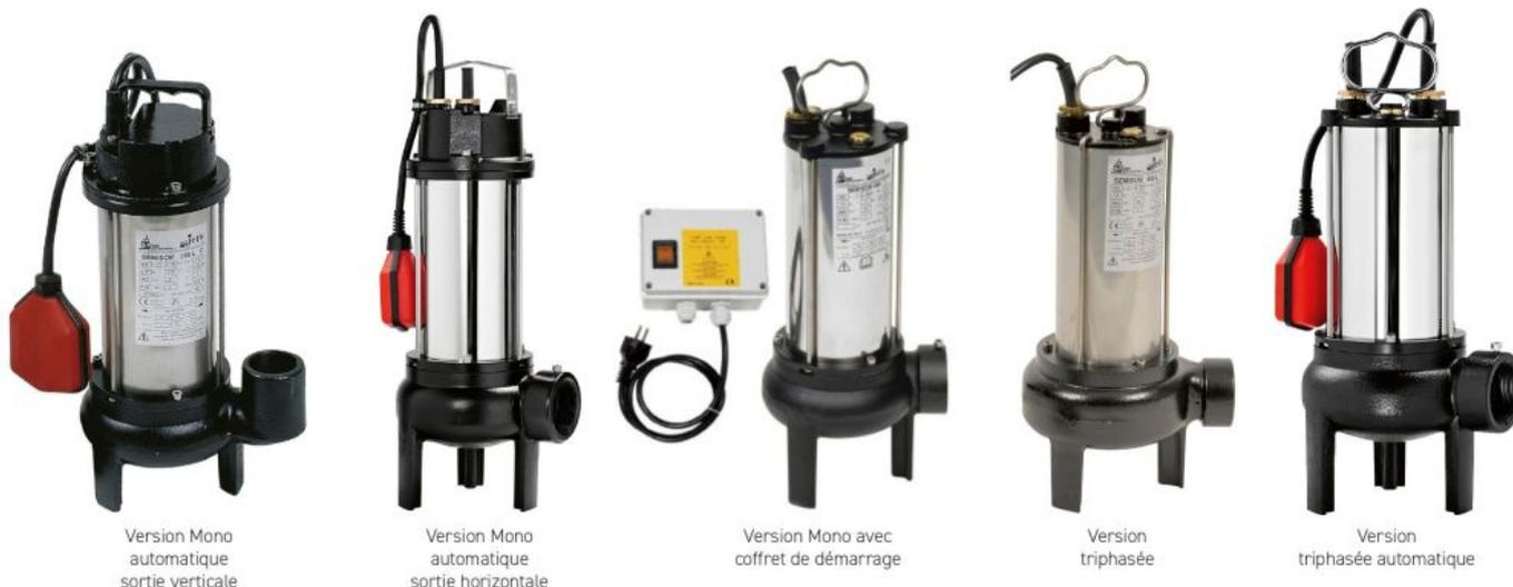
Les SEMISOM sont des pompes adaptées à l'évacuation des eaux chargées d'une habitation individuelle, d'une petite résidence, etc. vers un égout situé à un niveau ne permettant pas un écoulement gravitaire. Elles permettent de pomper des liquides chargés pouvant contenir des corps solides en suspension jusqu'à 50 mm de diamètre.
