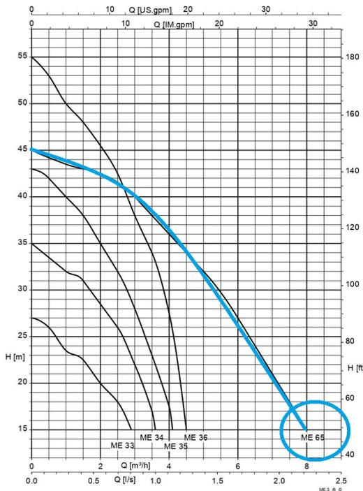
La hauteur manométrique totale est la somme de la hauteur d'aspiration + la hauteur de refolement + les pertes de charge dans les tuyauteries d'aspiration et de refolement + la pression résiduelle. Le débit dépend de la hauteur manométrique totale. Hauteur d'aspiration maximale pour toutes les tailles env. 8 m.
