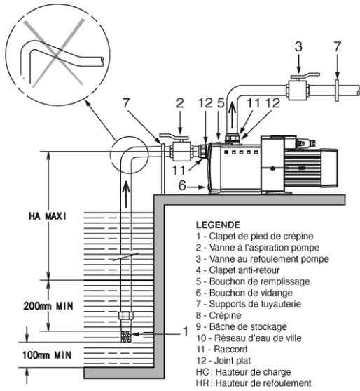
**• Claris home en charge sur bâche de stockage ou réseau de ville avec système de protection manque d'eau**
